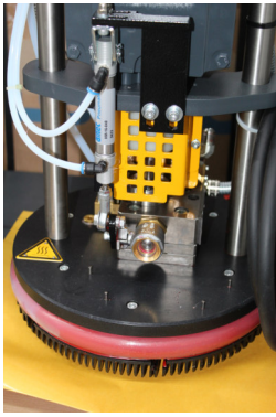
Schmelzplatte mit automatischer Entlüftung
