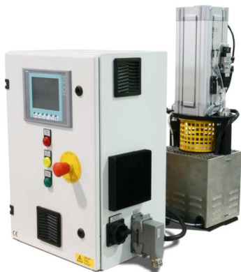
Schmelzgerät in Sonderausführung mit getrenntem SPS-Steuerschaltschrank und Touchpanel-Bedieneinheit
