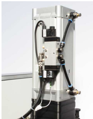
Positionstransmitter und pneumatisches Steuerventil am großvolumigen Press-Zylinder
