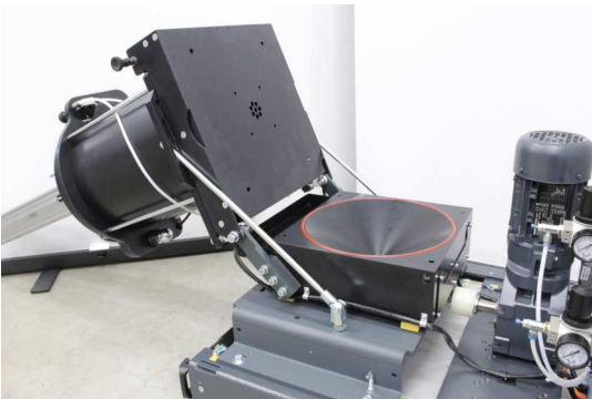
Wartungsfreundlicher Aufbau mit abklappbarem Schmelztrichter
