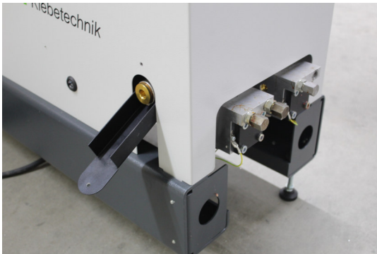
GS20 als Doppelpumpen-Variante mit Leimablass-Vorrichtung
