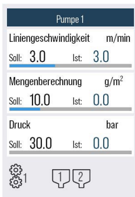
Menü „Dosiermeter“ Funktion - Automatische Drehzahlsteuerung nach Mengenvorgabe in \text{g/m}^2 oder \text{g/lfdm}
