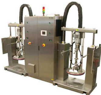
Tandem-Anlage: In V2A Version mit automatischer Change-Over Funktion
