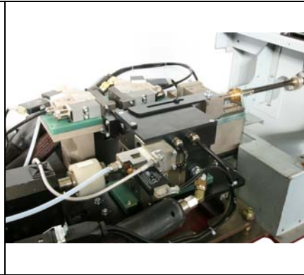
Kompl. Buchrückendüse mit zwei Seitenbeleimdüsen
