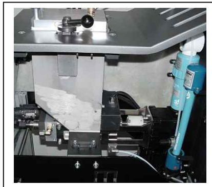
PUR-Ausführung mit integriertem Drucklufttrockner
