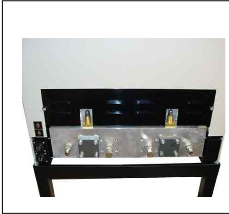
Zwei Pumpengerät mit Bypass
