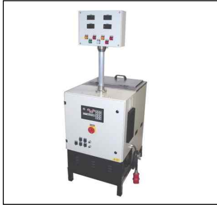
Gerät mit drehbarem Schaltschrank
