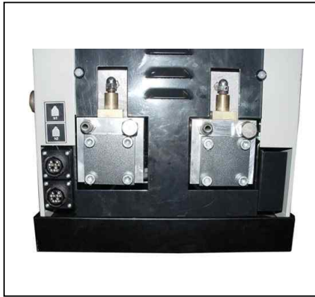
Zwei-Pumpbetrieb mit 2 Schläuchen
